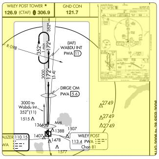
Figure 1-14. Holding in lieu of procedure turn.
